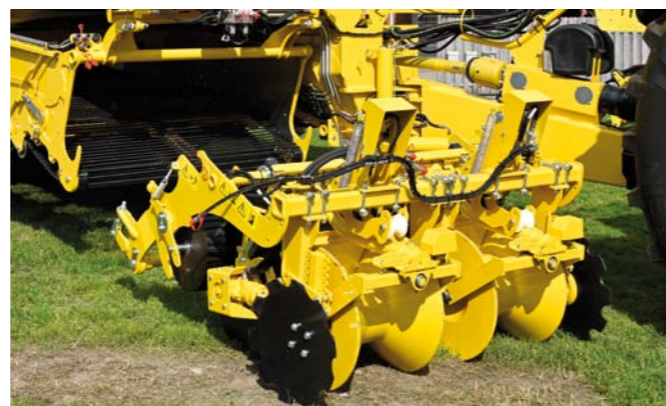
Hrůbkový příjem s vroubkovanými dutými disky na obou stranách
