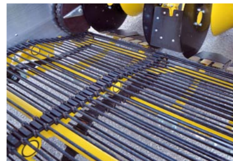
Drtič hrud v prosévacím pásu 1
