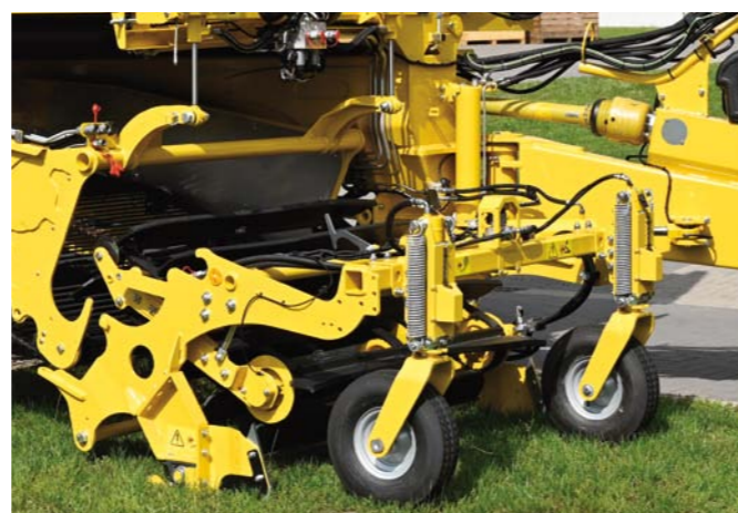
Hrůbkový příjem s vroubkovanými dutými disky na obou stranách
