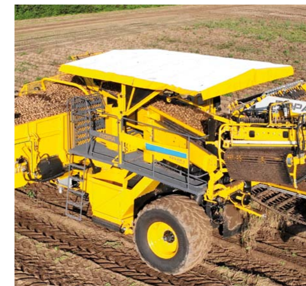
Ochranná stříška proti slunci, výškově nastavitelná (na přání, lze rozšířit o boční zakrytování)
