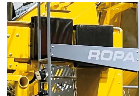
Polstrování na přebíracím stanovišti
