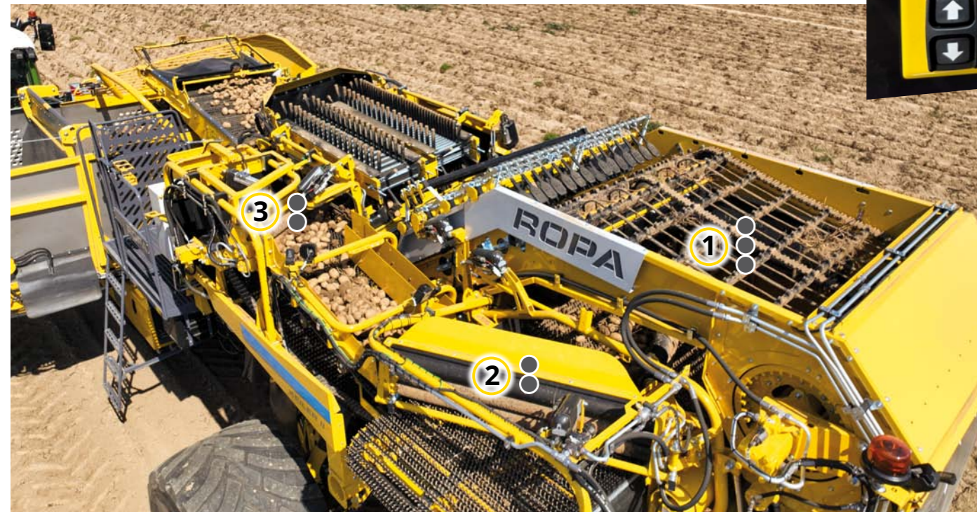
Výšku a sklon třídicího agregátu stroje lze pohodlně plynule hydraulicky a elektronicky nastavit stisknutím tlačítka
