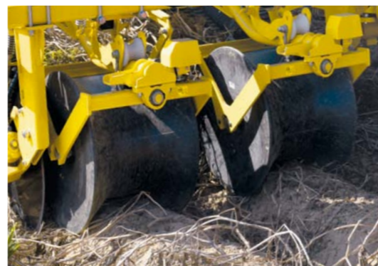
Hrůbkové bubny z plastu, hydraulicky poháněné krojidlo vnější
