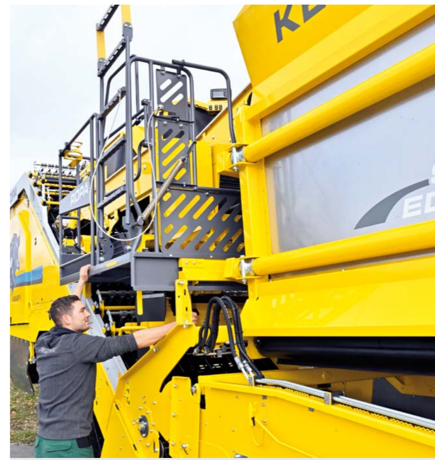
Pracovní plošina, výsuvná o 300 mm - velkorysá pracovní plocha pro větší volnost pohybu
