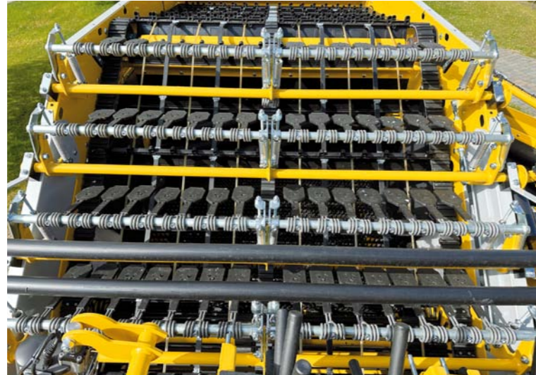
Zlepšení chodu naťového pásu a naťové přídržovací pružiny
