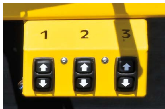
Nastavení výšky odváděcích válečků prostřednictvím lineárních pohonů Linak
