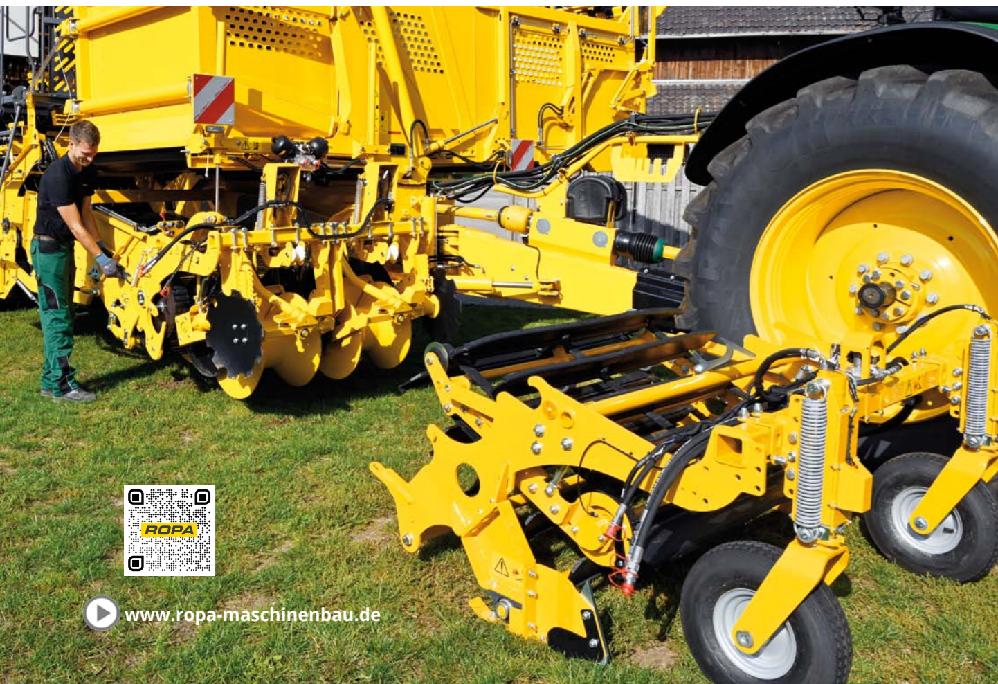
Hrůbkový příjem s vroubkovanými dutými disky na obou stranách
