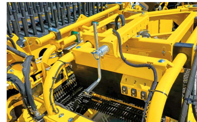
Horizontální posun odváděcích válců na ježku 3
