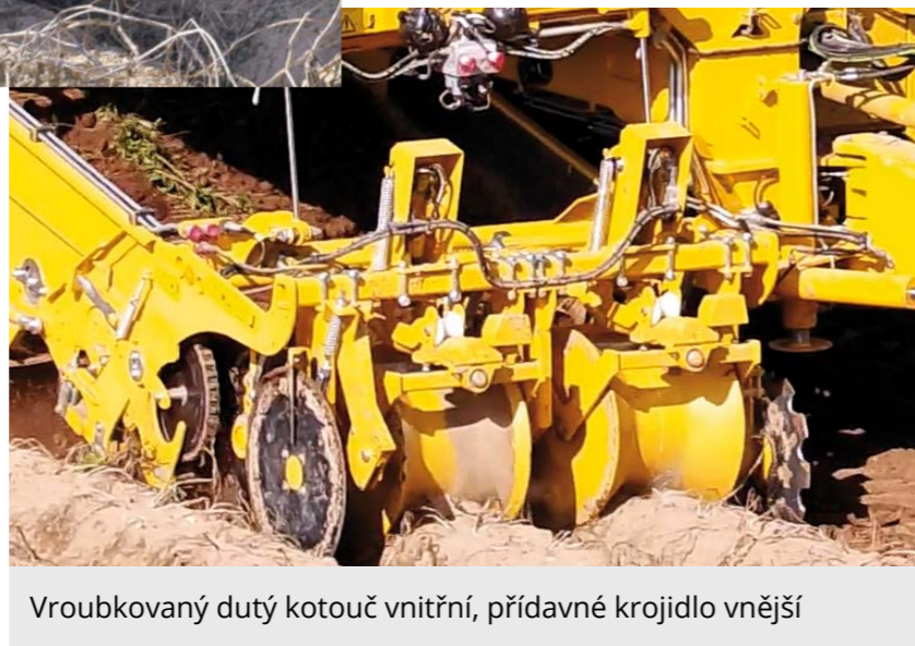
Až 4 hydraulicky poháněná krojidla (2x vnitřní, vnější vlevo a vpravo)
