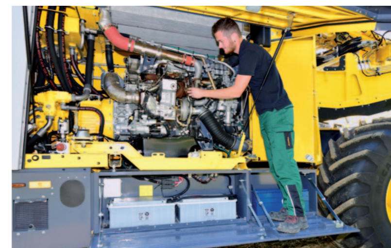
Mercedes-Benz OM936 – pro nakládací režim ve velmi snížených otáčkách (možné od 1 150 ot/min) a s velkou výkonovou rezervou za extrémních podmínek.
