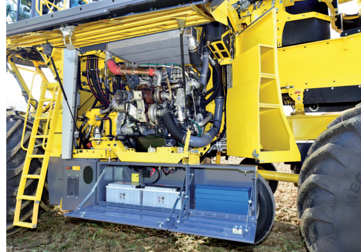
Mercedes-Benz OM936 – pro nakládací režim ve velmi snížených otáčkách (možné od 1 150 ot/min) a s velkou výkonovou rezervou za extrémních podmínek.
