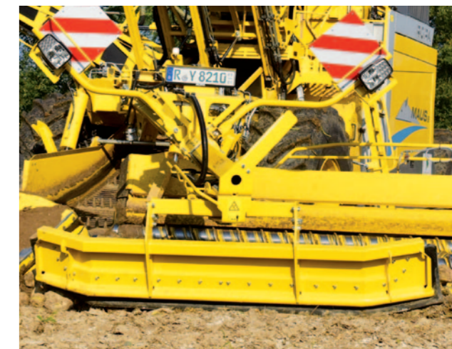
Přihrnovač a dočišťovač zbytků řepy se zahnutými rohy a zesílenou gumovou stěrkou.
