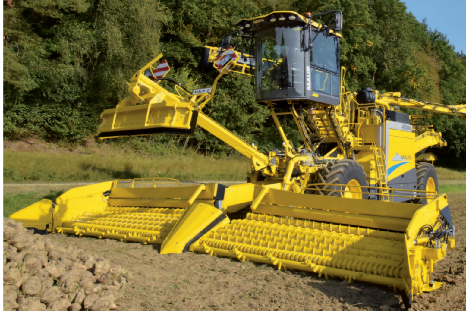
Samostatné pohony pro 3 skupiny válců s individuálním nastavením otáček a automatickou reverzací při zaklínění kamenů. Veškeré válce jsou standardně navařeny tvrdokovem.
