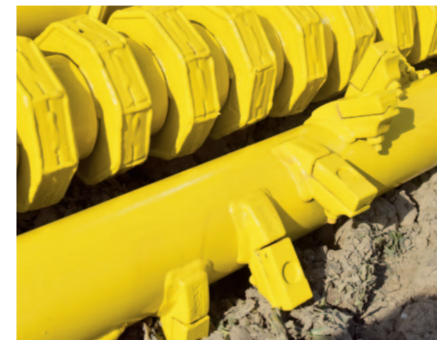
Vyměnitelné příjmové prsty odolné proti opotřebení s tvrdokovovými destičkami, čisticí válce s kovanými osmihrannými kotouči a návarem tvrdokovu.
