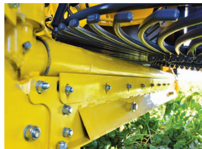
Přechodové otočné válce zabraňují hromadění zeminy
