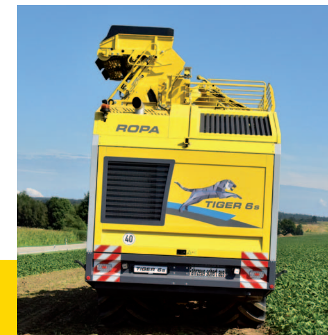
Hydraulický podvozek, automatické vyrovnání náklonu
